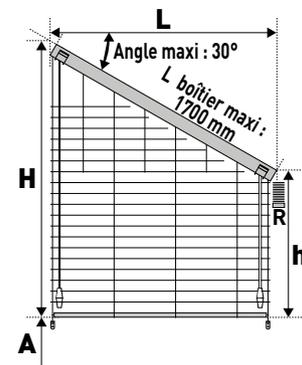
**Conseil pour le poseur** : Si guidage, prévoir de le fixer en partie basse à H + 15 mm pour éviter que la barre de charge ne bute dessus trop tôt. **Si guidage, nous vous conseillons :**
