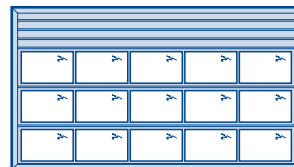
Motif 480 – Avec cadre en aluminium type N avec vitre double synthétique DURATEC
