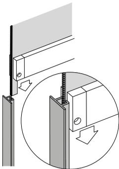
Guidage par « Zip » assurant une parfaite tenue au vent
