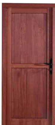
Porte de service Exotique : cadre de 32 mm , panneaux frises verticales ép. 27 mm , ferrage par paumelles, poignée fournie, serrure 3 points encastrée
