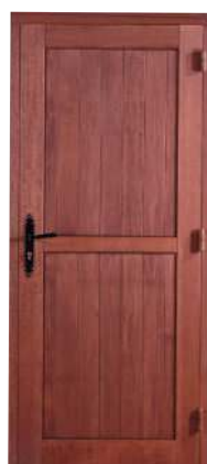
Porte de service Exotique : cadre de 32 mm , panneaux frises verticales ép. 27 mm , ferrage par paumelles, poignée fournie, serrure 3 points encastrée
